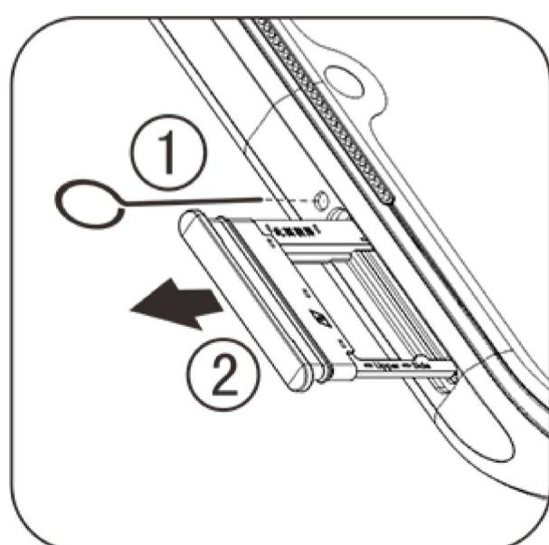
2. أجعل الوجه المعدني لبطاقة Micro SD (Nano) أو بطاقة SIM1/SIM2 متوجهاً للأسفل، حيث تتوافق الزاوية المائلة مع تلك الزاوية بدرج البطاقة. ضع بطاقة Micro SD (Nano) أو بطاقة SIM1/SIM2 في فتحة البطاقة وفق الاتجاه المحدد بالأسهم بالرسم البياني.
