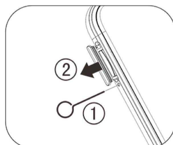
2. اجعل الوجه المعدني لبطاقة Micro SD (Nano) أو بطاقة SIM1/SIM2 متوجهاً للأسفل، حيث تتوافق الزاوية المائلة مع تلك الزاوية بدرج البطاقة. ضع بطاقة Micro SD (Nano) أو بطاقة SIM1/SIM2 في فتحة البطاقة وفق الاتجاه المحدد بالأسماء بالرسم البياني.
