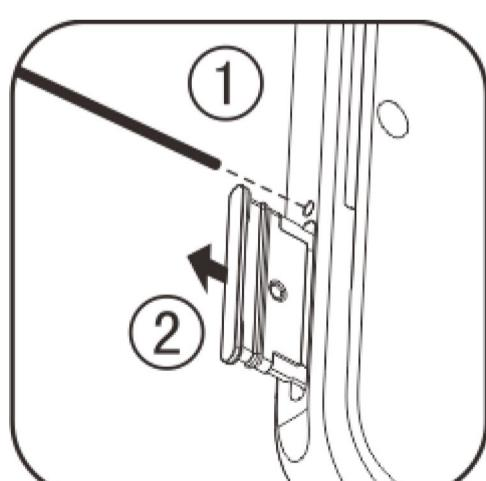
2. اجعل الوجه المعدني لبطاقة Micro SD (Nano) أو بطاقة SIM1/SIM2 (Nano) متوجهاً للأسفل، حيث تتوافق الزاوية المائلة مع تلك الزاوية بدرج البطاقة. ضع بطاقة Micro SD (Nano) أو بطاقة SIM1/SIM2 (Nano) في فتحة البطاقة وفق الاتجاه المحدد بالأسهم بالرسم البياني.
