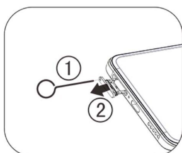
2. اتبع اتجاه السهم الموضح في الرسم وقم بتركيب الزاوية المائلة لبطاقة SIM الخاصة بك في الزاوية المائلة للدرج.
