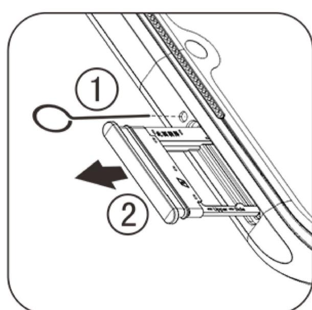
2. أجعل الوجه المعدني لبطاقة Micro SD أو بطاقة Nano-SIM1/SIM2 متوجهاً للأسفل، حيث تتوافق الزاوية المائلة مع تلك الزاوية بدرج البطاقة. ضع بطاقة Micro SD أو بطاقة Nano-SIM1/SIM2 في فتحة البطاقة وفق الاتجاه المحدد بالأسهم بالرسم البياني.
