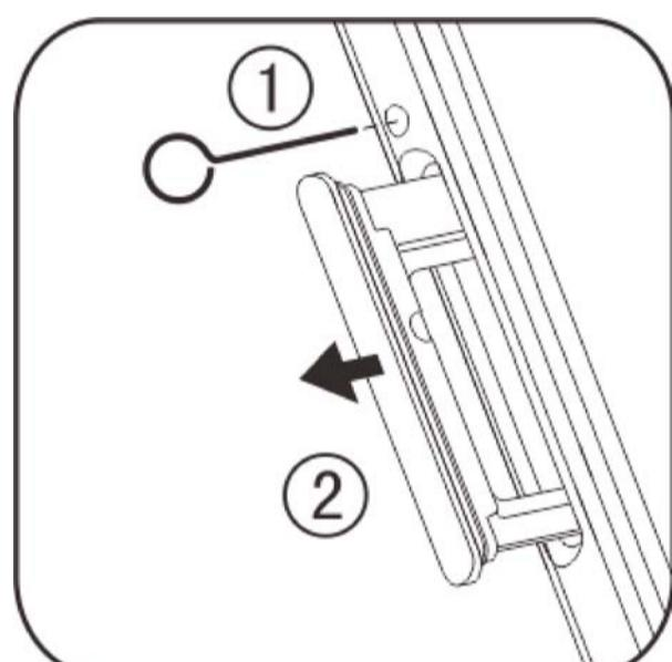
2. أجعل الوجه المعدني لبطاقة Micro SD أو بطاقة Nano-SIM1/SIM2 متوجهاً للأسفل، حيث تتوافق الزاوية المائلة مع تلك الزاوية بدرج البطاقة. ضع بطاقة Micro SD أو بطاقة Nano-SIM1/SIM2 في فتحة البطاقة وفق الاتجاه المحدد بالأسماء بالرسم البياني.
