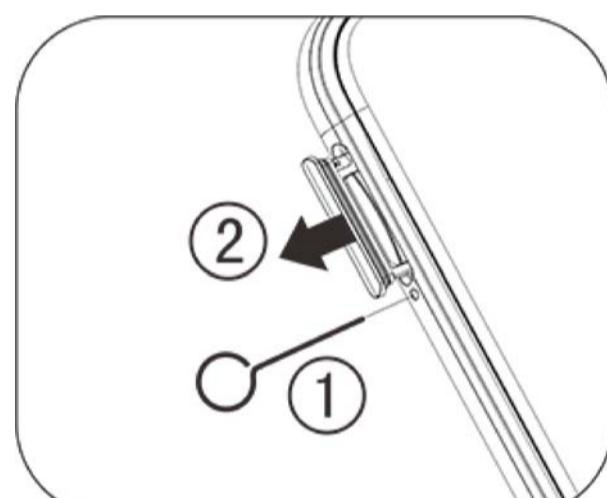
2. أجعل الوجه المعدني لبطاقة Micro SD أو بطاقة Nano-SIM1/SIM2 متوجهاً للأسفل، حيث تتوافق الزاوية المائلة مع تلك الزاوية بدرج البطاقة. ضع بطاقة Micro SD أو بطاقة Nano-SIM1/SIM2 في فتحة البطاقة وفق الاتجاه المحدد بالأسماء بالرسم البياني.
