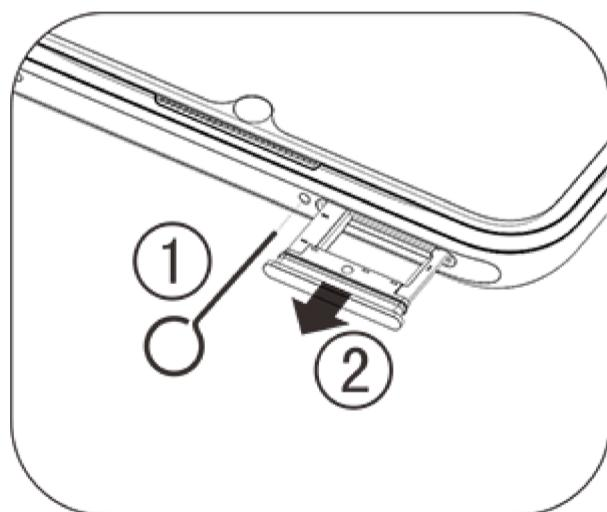
2. أجعل الوجه المعدني لبطاقة Micro SD أو بطاقة Nano-SIM1/SIM2 متوجهاً للأسفل، حيث تتوافق الزاوية المائلة مع تلك الزاوية بدرج البطاقة. ضع بطاقة Micro SD أو بطاقة Nano-SIM1/SIM2 في فتحة البطاقة وفق الاتجاه المحدد بالأسهم بالرسم البياني.
